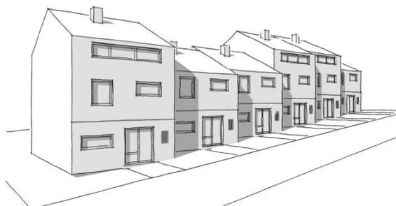
**Abb. 18: Erweiterungsmöglichkeit Haustypen 1 und 2 mit maximal 2 Meter hohem Dremfel, eigene Darstellung**
